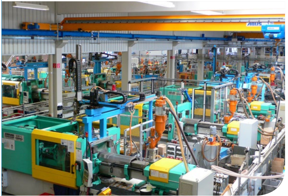
Im Werk Illertissen werden jährlich auf über 60 Spritzgießmaschinen rund 2.200 t Rohmaterial verarbeitet.
