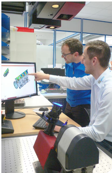
Mit der Streifenlichtmessung schließt Weiss den Kreis von der CAD-Zeichnung über die Kunststoffverarbeitung bis zurück zum CAD-Datensatz.
