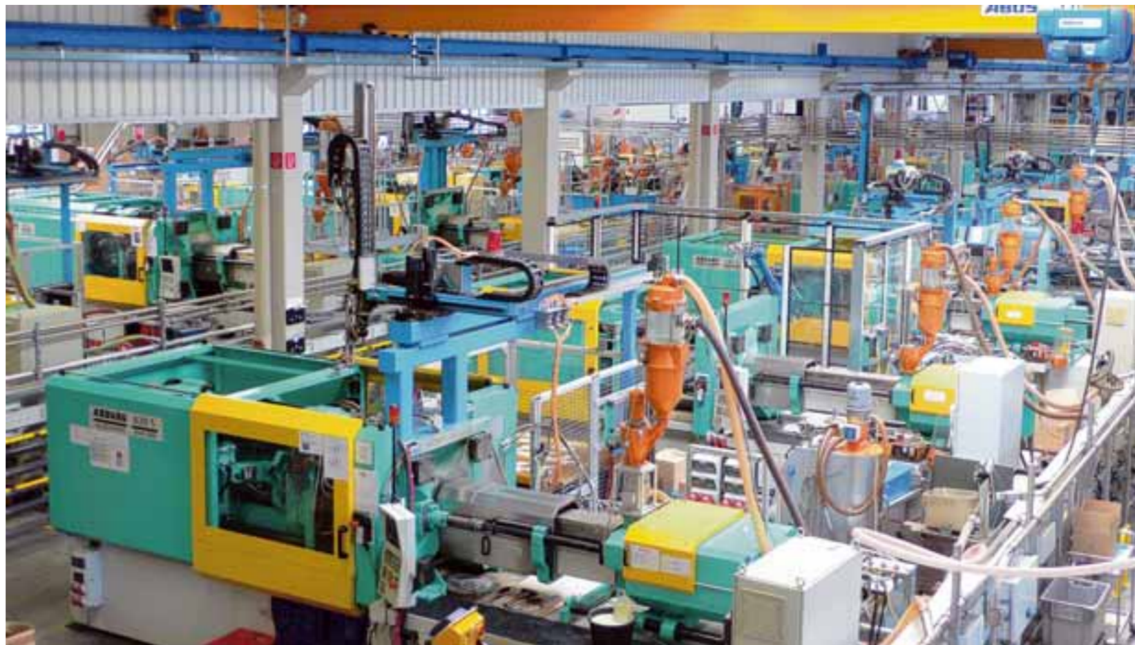
Der Maschinenpark des Illertisser Unternehmens Weiss: Die kapitalintensive Firma gehört in Deutschland zu den Großen im Bereich Kunststoff-Spritzguss. Zur Hälfte kommen die Kunden aus der Automobilindustrie.
